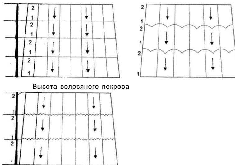
Рис. 40. Виды соединений шкурок кролика:
