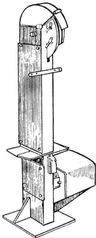
Рис. 25. Машина мездрильная дисковая для ручной обработки шкур
